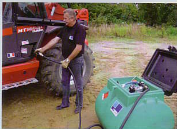
L'utilisation du gasoil à la place du fioul fait naître des interrogations auprès des professionnels, notamment à cause de sa tenue au froid. La nature même du gasoil est différente selon la saison de sa commercialisation.
